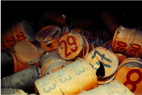
Foto 34: Fallversuche mit inaktiven Abfallfässern aus 70 m Höhe in einem Blindschacht von Asse II für das EURATOM-Kavernenprojekt
