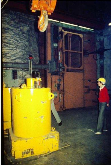
**Foto 7: Typ B2-Abschirmbehälter für Transport und Endlagerung der MAW-Fässer vor dem Schachteingang Asse 2 auf der 490-m-Sohle**
