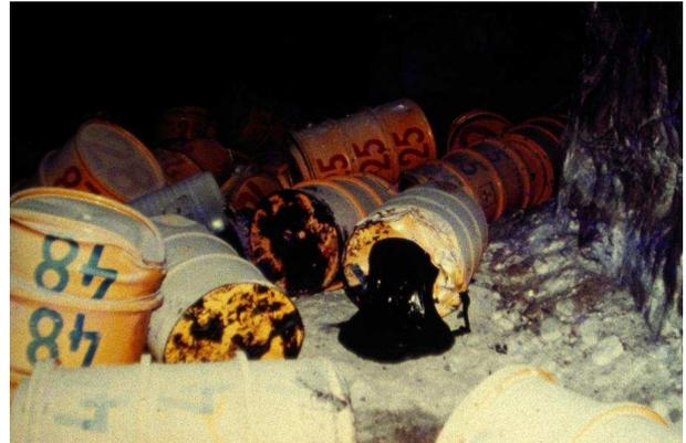
Foto 35: Fallversuche mit inaktiven Abfallfässern zur besseren Raumfüllung der 10.000 m<sup>3</sup> fassenden Kaverne des EURATOM-Kavernenprojektes
