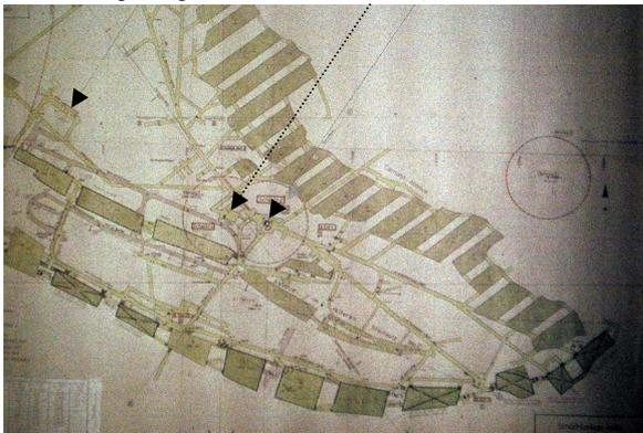
Foto 27: Grundriss der 750-m-Sohle von Asse II mit gekennzeichneten Einlagerungskammern für „schwachradioaktiven“ Abfall im südlich gelegenen Jüngerem Steinsalz Na3 und AVR-Einlagerungsstrecke im Sattelkern des Älteren Steinsalzes Na2, angrenzend an den Sicherheitspfeiler der ersoffenen Schichtanlage Asse I
